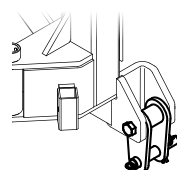
Articulation pour autonivellement du broyeur
