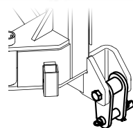
Articulation pour autonivellement du broyeur
