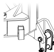
Articulation pour autonivellement du broyeur
