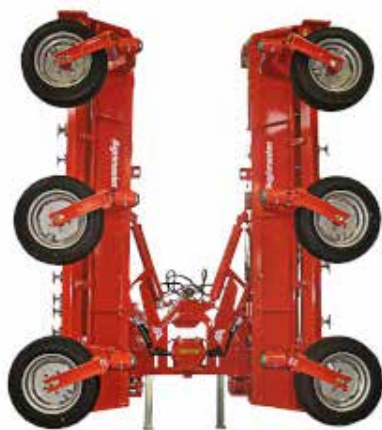
SPU mit 180° Schwenkräder
