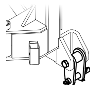
3D-Kopplung für optimale Boden-anpassung (Option)
