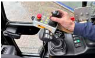
Mit einem Joystick proportional gesteuert
