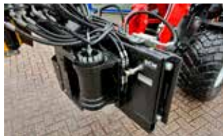
180 Grad Links-Rechts-Drehung mit Schwenkmotor
