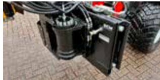
180° links-rechts rotatie met zwenkmotor
