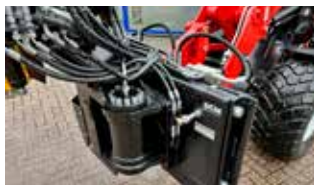
Rotation gauche-droite de 180° avec moteur pivotant
