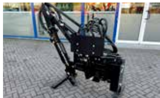
Rotation gauche-droite de 110° avec moteur pivotant
