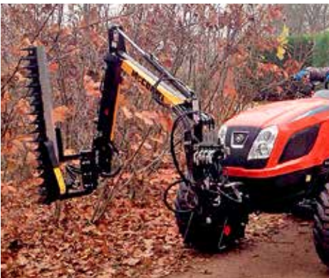
Swingtrim pour montage frontal sans protection contre les chocs
