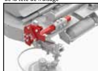
Adaptateur pour le montage du système de commande mécanique de la tête de fraisage sur le modèle LV
