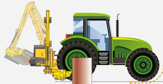
Dank der hydraulischen Sicherheitsauskupplung kann der Power Arm bei Kontakt mit einem Hindernis nach hinten und oben ausbrechen.
