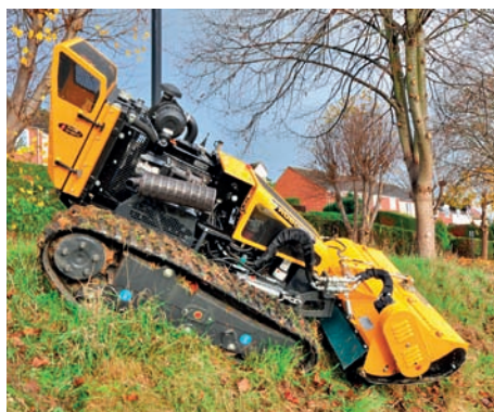
Die neuen, ferngesteuerten Roboter mäher sind unter anderem für die Pflege von steilen Hängen und unzugänglichen Flächen gedacht.
