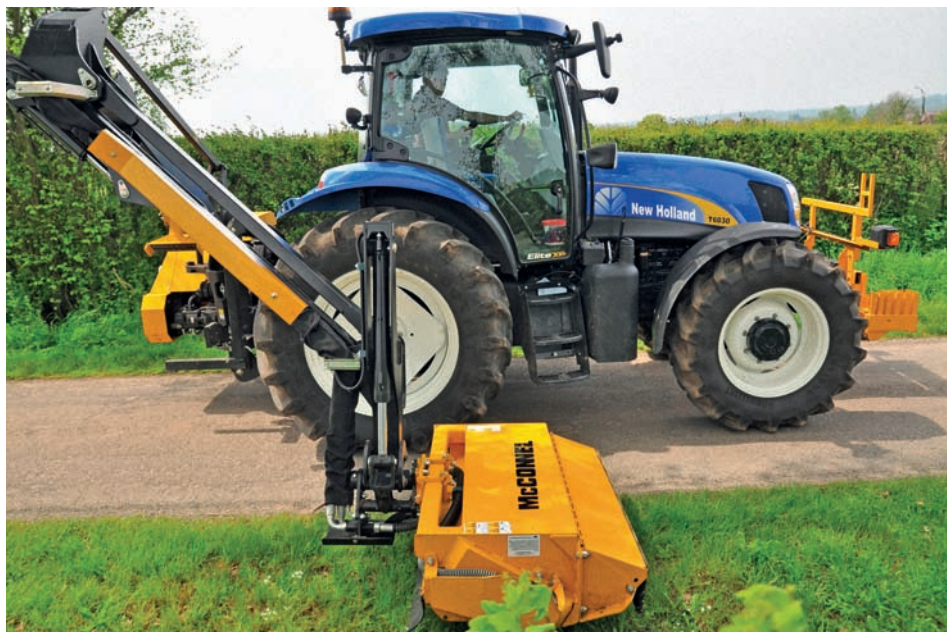
Mit Hilfe des so genannten VFR-Systems arbeitet der Mähkopf neben der Fahrerkabine und ermöglicht somit trotz Heckanbau gute Sicht auf die Arbeitsfläche.
