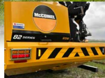
Integrierte LED Beleuchtungsanlage mit Blitzlicht
