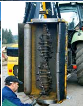
Alle Anbaugeräte sind sehr massiv und damit bedenkenlos für den professionellen Einsatz geeignet. Beim Mulchkopf sind die Messer auf der Welle spiralförmig angeordnet.
