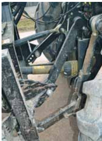
Geräte dieser Größe werden meist mit Achsanbau gefahren, nicht rein in der Drei-Punkt.
