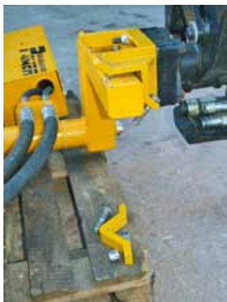
Die Montage eines anderen Kopfes dauert etwa 15 Minuten. Optional gibt es einen Schnellwechsler.
